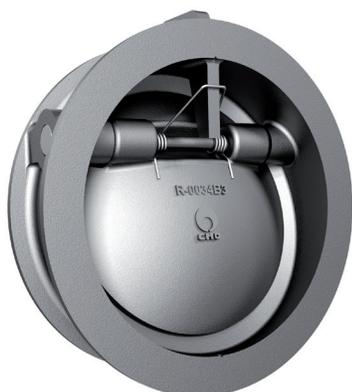
Bezpřírubová zpětná klapka s jednodílným tělesem a diskem na čepu, která umožňuje snadný odvod nečistot obsažených v médiu. Průtok se otevírá tlakem proudícího média a zavírá vahou disku při ukončení proudění. Klapka může být dodána s pružinou, která zajistí rychlejší a lepší utěsnění průtoku. Pro vyšší tlakové zatížení a větší DN se zpětná klapka dodává s hydraulickým tlumičem tlakových rázů.
