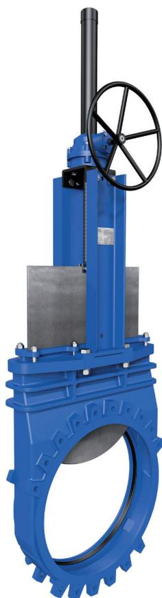
Jednosměrné bezpřírubové nožové šoupátko s jednodílným litým tělesem s otvory pro snadné čištění, vedením nože, nerezovým nožem a různými typy těsnícího sedla. Umožňuje plný průtok pracovní látky s velmi nízkou tlakovou ztrátou. Typ FK je varianta s víkem.
