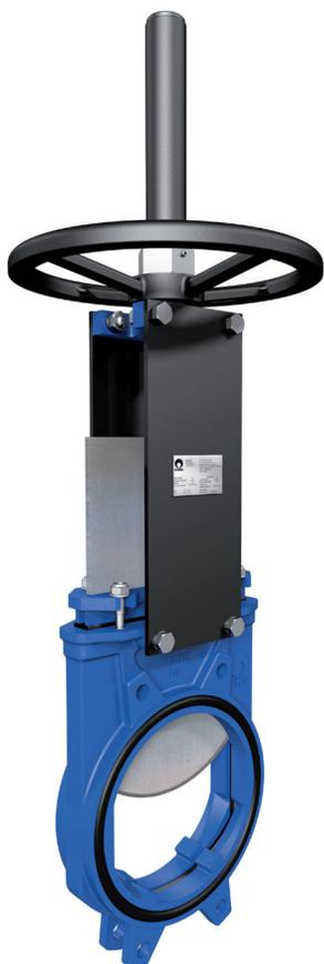
Obousměrné bezpřírubové nožové šoupátko s jednodílným litým tělesem, vedením nože, nerezovým nožem a těsnícím sedlem. Umožňuje plný průtok pracovní látky s velmi nízkou tlakovou ztrátou.
