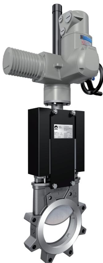
Jednosměrné nožové šoupátko s připojením mezi přírubou pomocí závitových ok (LUG) s jednodílným tělesem. Konstrukce podle norem MSS-SP-81 a TAPPI TIS405-8 s jednodílným litým tělesem a vnitřními kluznými plochami pro optimální pohyb nože. Umožňuje plný průtok pracovní látky s nízkou tlakovou ztrátou.
