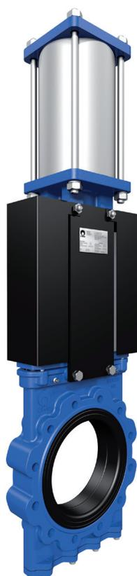
Obousměrné nožové šoupátko s tělesem se závitovými oky (LUG). Těleso je jednodílné těleso (monoblok) z lité oceli s nerezový nožem a dvěma gumovými těsněními. Umožňuje plný průtok pracovní látky s nízkou tlakovou ztrátou.
